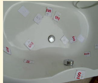
Kratzer und Kerben im Wannenboden aus Acryl
