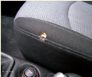
Sengschaden im Stoff vorher
