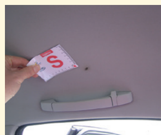
Sengloch Dachhimmel vorher
