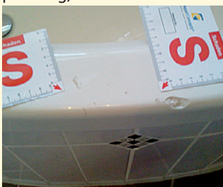
Einkerbungen/Splitterungen am Wannenrand aus Acryl
